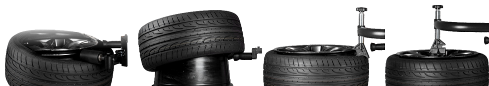
压胎轮 - 提供压胎功能 Roller - bead pressing
